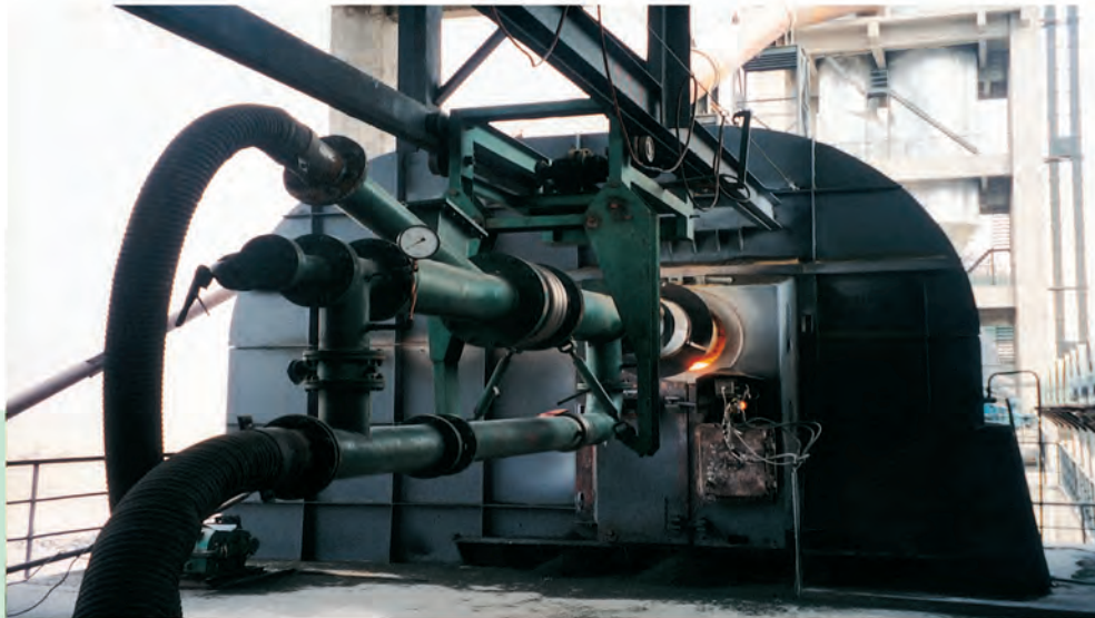
用于巴基斯坦Attock水泥有限公司3000t/d预分解窑窑头四通道燃烧器
