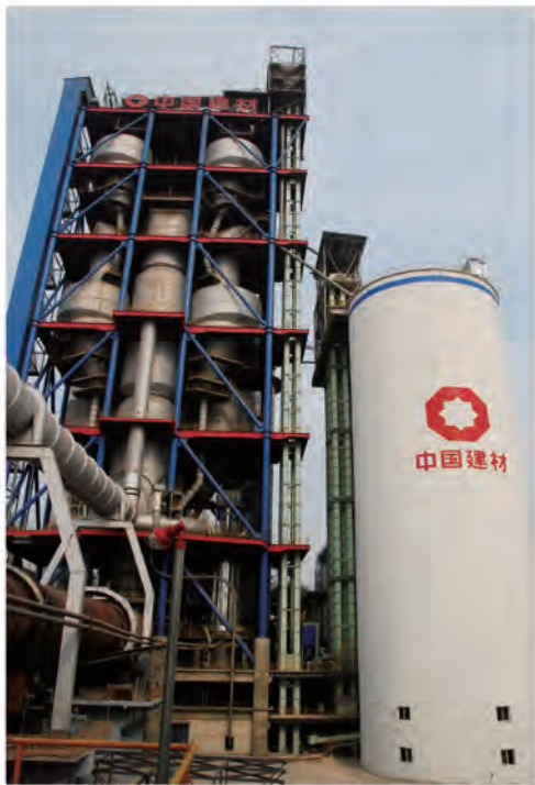
配套10000t/d生产线的钢丝胶带斗式提升机 Elevators for 10000 t/d cement production line
