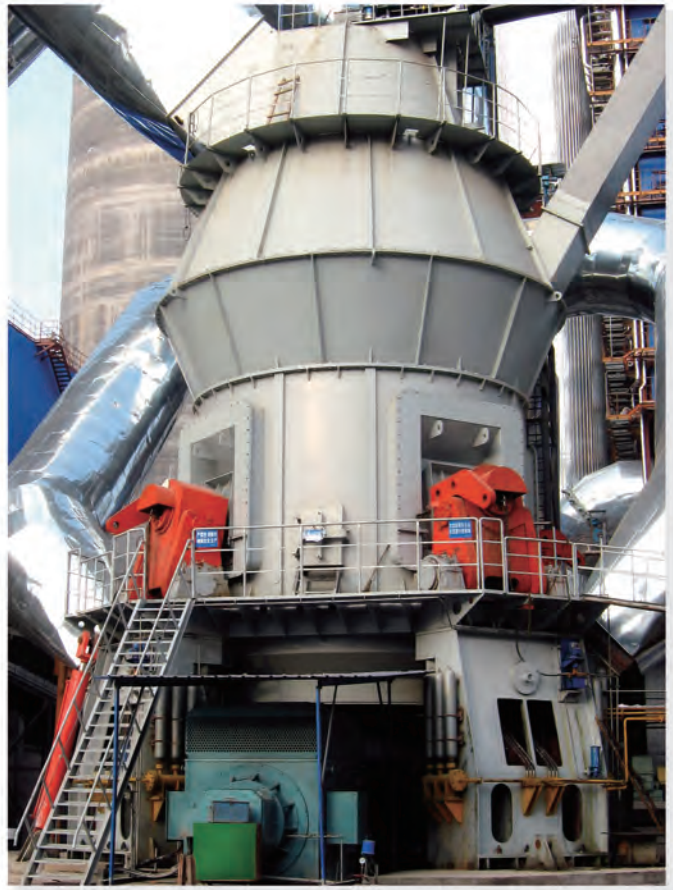
南方水泥浙江虎山集团5000t/d生产线大型原料立式磨HRM4800
